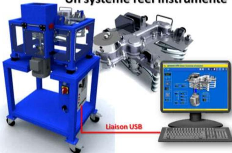
Issu de la technologie embarquée **Selectiv' Process** Winery de Pellenc, le système Egreneur SPW permet d'étudier le mécanisme breveté utilisé pour séparer les grains de raisins de leur rafle par accélération.
