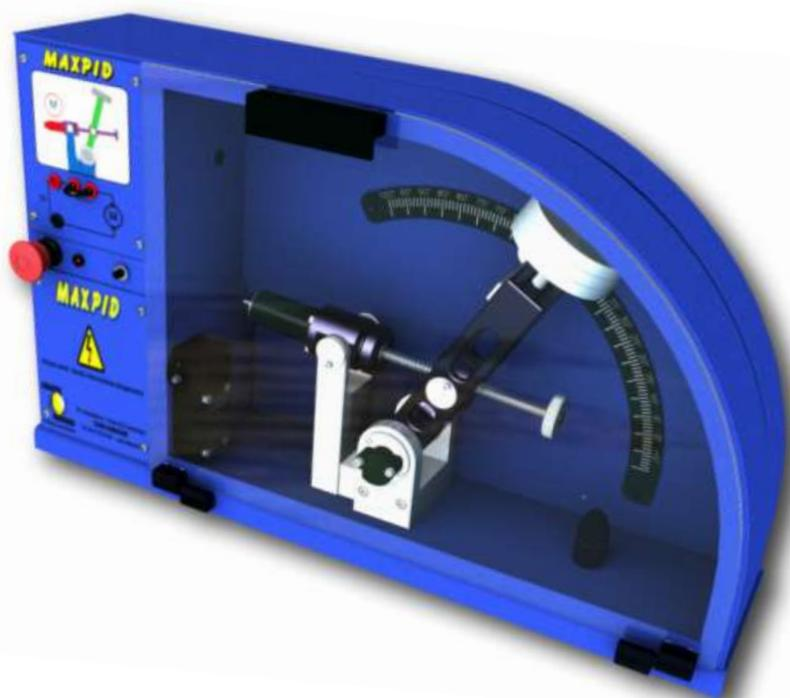
Chaîne asservie en position issu de technologies mécatroniques industrielles, permettant une approche expérimentale et intuitive des asservissements de positions.
